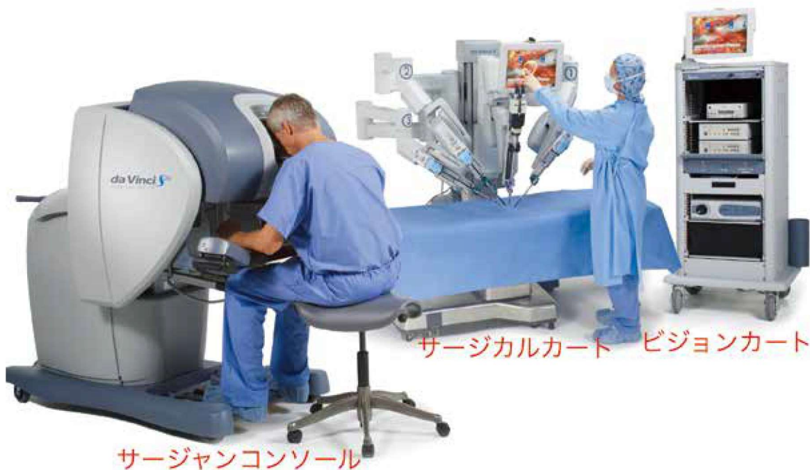
図1 ダヴィンチサージカルシステム。サージカルカート(中)、ビジョンカート(右)、サージャンコンソール(左)
